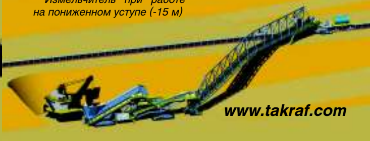
Измельчитель на пониженном уступе (-15 м), с конвейерным вагоном, движущимся по скату 1:20
