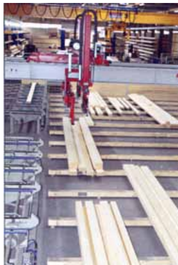
7. Комплектующий кран с вакуумным грейфером укладывает отдельные детали в пакеты.
