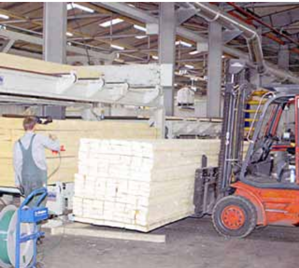
4. Подача пакетов сырья на разобшение и сортировку по классам
