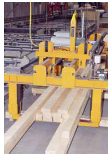
8. Мостовой кран с захватом пакетов осуществляет транспортировку к упаковочной станции.
