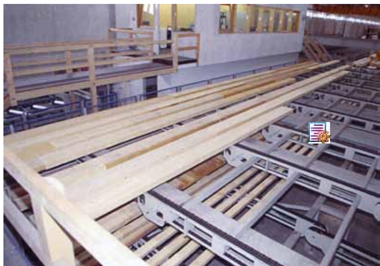
3. На двухэтажном буферном транспортере происходит затверждение шипового соединения. На заднем плане - станция управления, из которой хорошо виден весь процесс.
