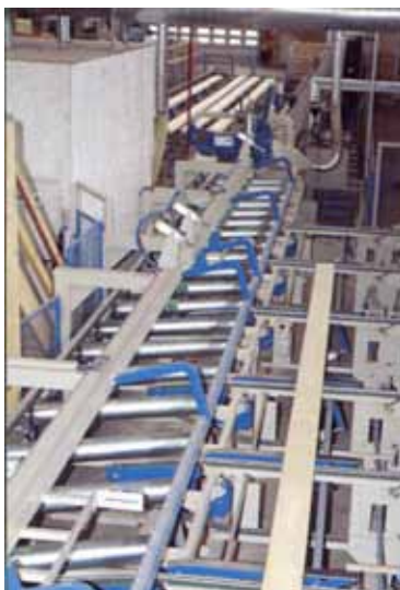
5. После струга производится торцовка с точностью до 1 мм. Каждая деталь снабжается этикеткой на торце
