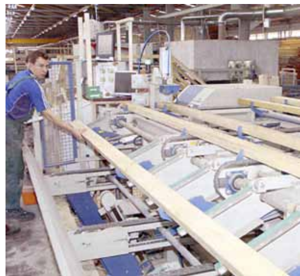
6. Станция сортировки с поворотом на 360° для общего визуального контроля.
