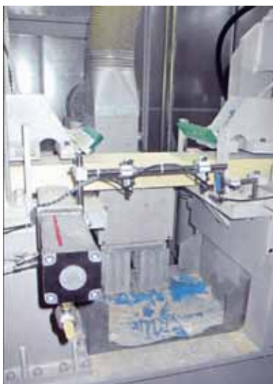
2. Во время прессования устройства фрезерования и нанесения клея находятся в позиции ожидания
